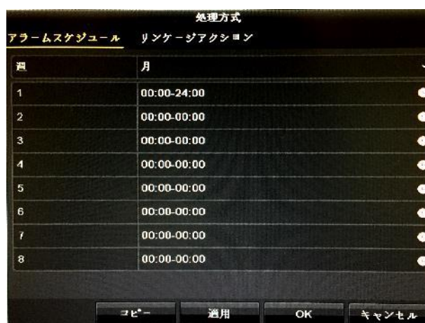
図 8.11 ビデオロスの警戒スケジュールを設定します。
