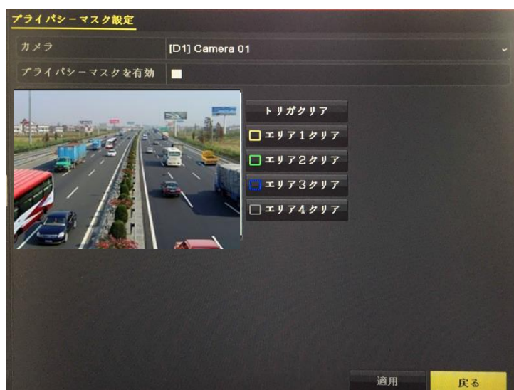
図 14.3 プライバシー マスク設定インターフェイス
