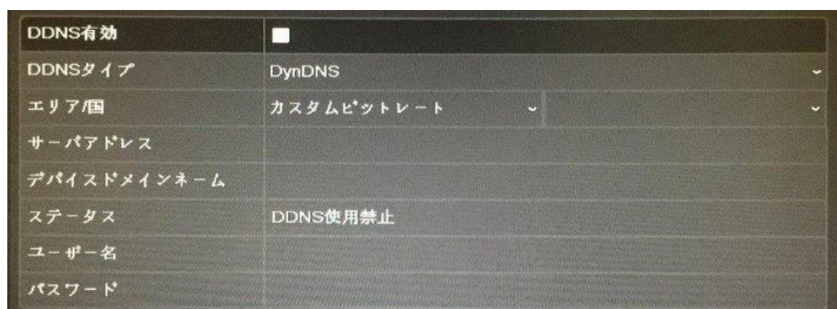
図 12.4 IP Server 設定インターフェイス
