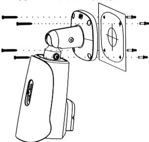
Step 3 カメラの電源を入れ、モニターを接続し、カメラの画面を対応する領域に調整します。カメラの位置を調整する必要がある場合は、ブラケットの2軸ネジを緩めて手で位置を調整します。調整が終わったら、図3-2に示すようにネジを締めます。
