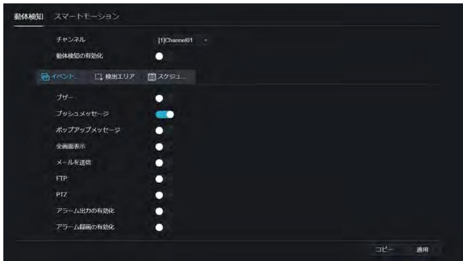
2. チャンネルのドロップダウンリストからチャンネルを選択します。
