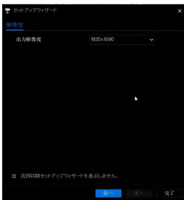
**ステップ 9:** [完了]をクリックして設定ガイドを終了します。[次回この設定ガイドを表示しない]にチェックを入れると、次回からウィザードは表示されません。ウィザードを再表示するには、[システム] > [ユーザーアカウント] > [詳細設定]に移動します。
