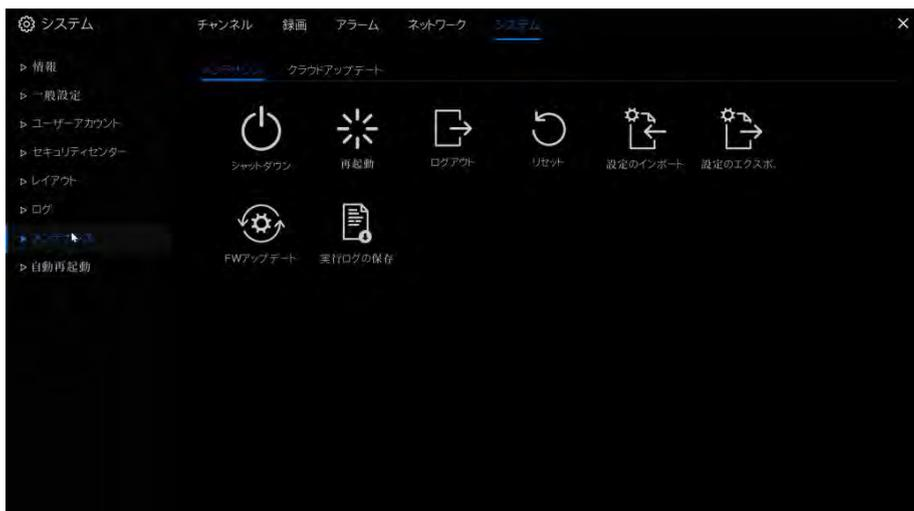
2. 「シャットダウン」、「再起動」、「ログアウト」、「リセット」をクリックして、必要に応じて DVR を操作します。
