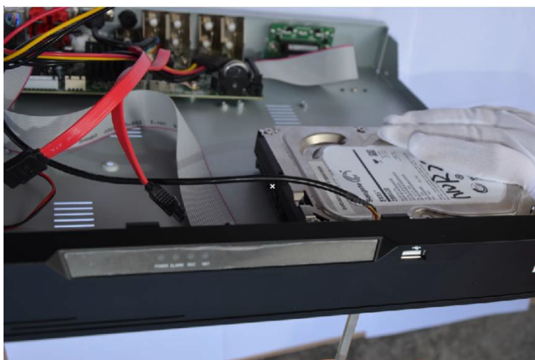
図 3-2 ハードディスクの取り付け
