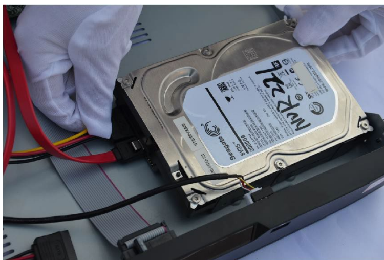
図 3-3 ハードディスクの取り付け
