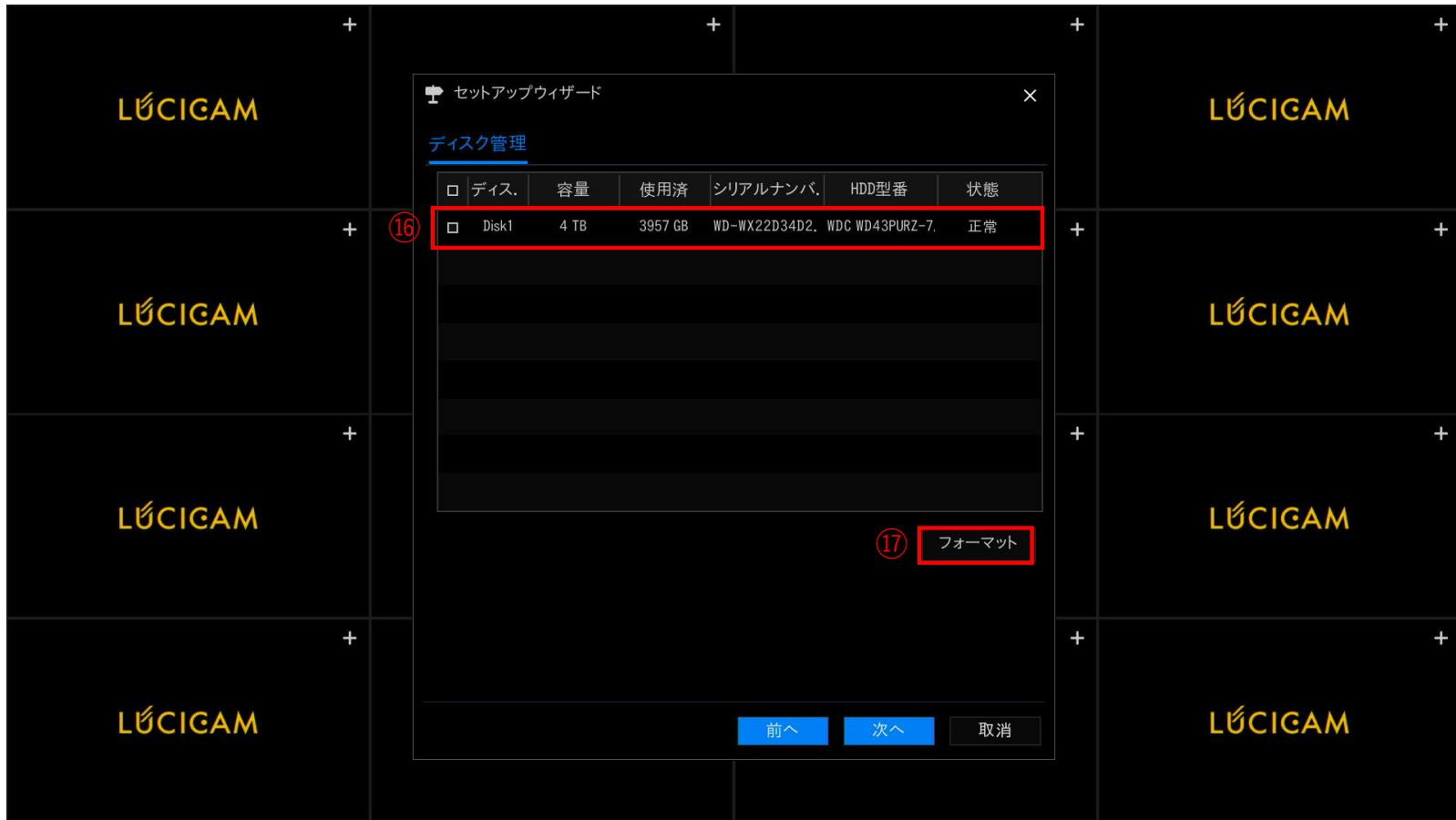
ハードディスクのフォーマットを行います。初めて製品を起動する場合、ハードディスクのフォーマットを行わないと、エラーが表示され正常に録画できなくなりますので、**フォーマットを実施してください。** フォーマットを行うとハードディスクの録画データが削除されます。
