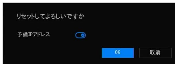
**IP アドレスの変更**：オンライン状態のカメラの IP アドレスを変更できます。「IP アドレスの変更」をクリックして、次の図のように変更し、新しい IP アドレスとサブネットマスクを入力します。
