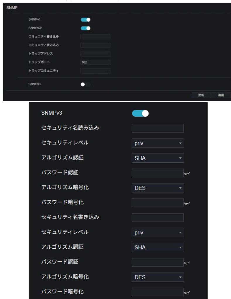
ステップ 2：SNMP (Simple Network Management Protocol) の情報を入力します。SNMP には 3 つの機能があり、必要に応じて適用できます。
