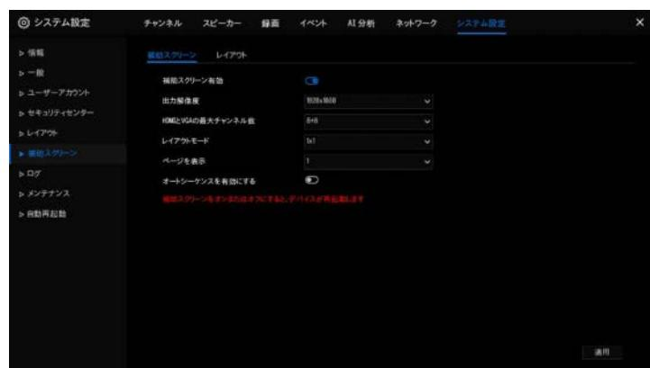
ステップ 3：出力解像度、デコード能力（メイン+補助）、レイアウトモード、表示チャンネルを設定します。
