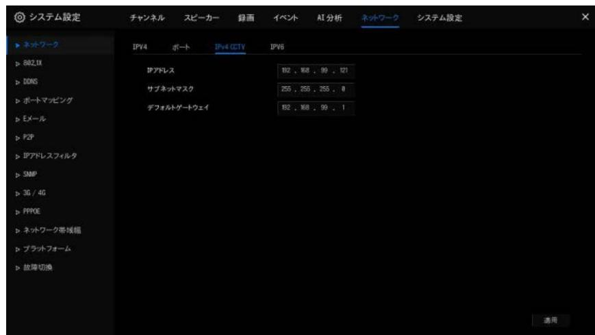
ステップ 2：IP アドレス、サブネットマスク、デフォルトゲートウェイを入力します。
