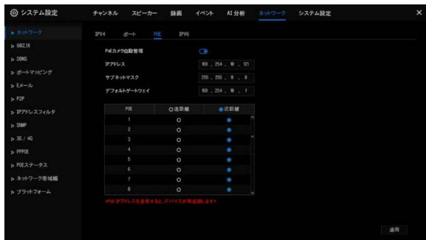
**ステップ2** : POE カメラの自動管理が有効になっている場合、NVR は POE に接続されたカメラに IP アドレスを即座に割り当てます。
