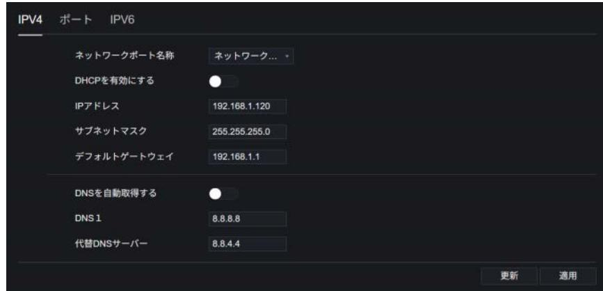
**ステップ 2：**ドロップダウンリストからネットワークカードを選択します。図 8-53 に示すように、ネットワークカード I は LAN1、ネットワークカード II は LAN2 です。
