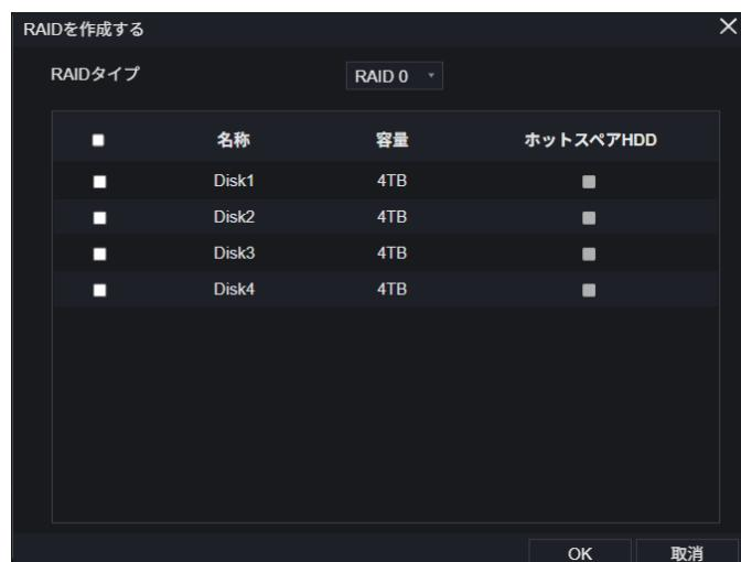
ステップ2：作成をクリックして、新しい RAID を作成する HDD を選択します。
