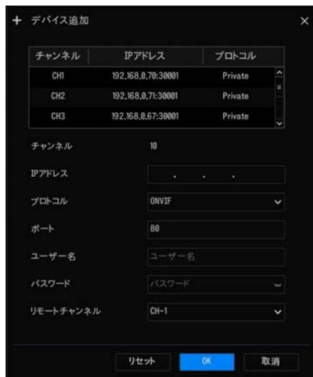
ステップ2：カメラのIPアドレス、ポート、ユーザー名、パスワードを入力します。オンラインカメラのIPをダブルクリックすると、設定がコピーされます。他のチャンネルのパラメーターを素早く変更できます。
