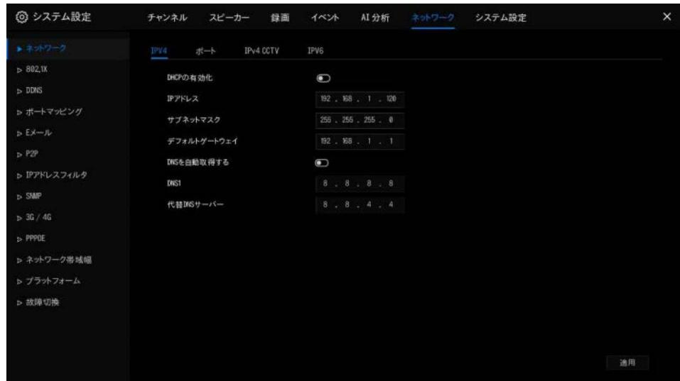
**ステップ2** : この機能が無効になっている場合は、「IP」、「サブネットマスク」、「デフォルトゲートウェイ」の横にある入力ボックスをクリックして、必要に応じてパラメーターを設定します。設定形式については、ルーターのネットワークを参照してください。
