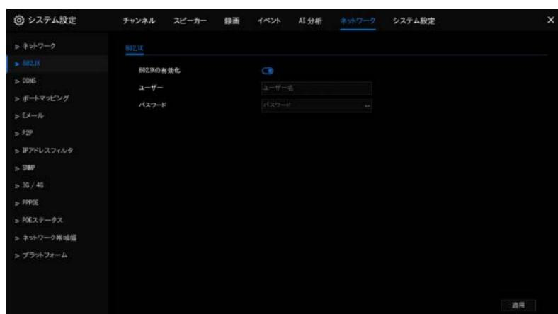
**ステップ2** : 802.1X のユーザー名とパスワードを入力します。アカウントはユーザーが作成します。
